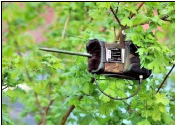
**Abb. 6:** Batcorder im Einsatz. Das Mikrofon befindet sich links, an der Spitze des Stabes. Das Gerät wird im Rahmen der stationären automatischen Fledermaus-erfassung verwendet.
