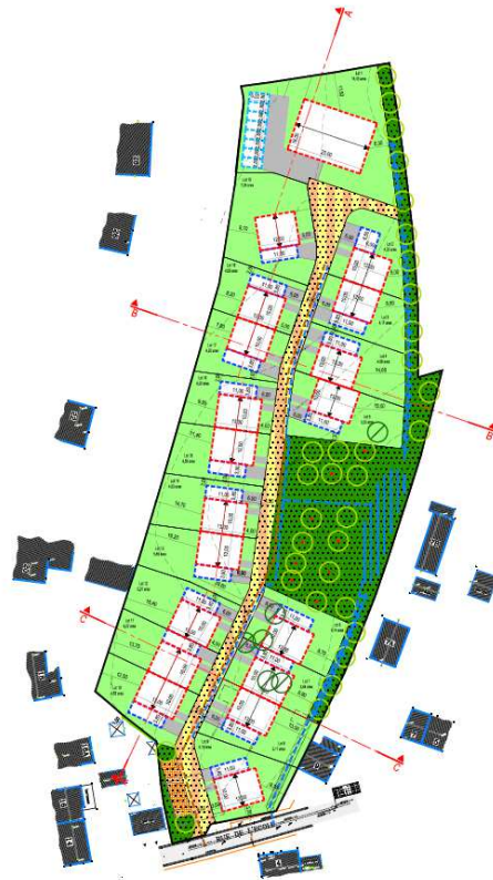
ABBILDUNG 10: VORENTWURF DER PLANSITUATION - BIOTOPE UND STRUKTUREN DER PLANUNG IM SINNE DER BIOTOPKLASSIFIZIERUNG: BIOTOPE IN ÖFFENTLICHER HAND (DUNKELGRÜN), ERHALTENE BÄUME (GELBER KREIS, MIT PUNKT), NEU ZU PFLANZENDE BÄUME (GRÜNER KREIS) (SIMON-CHRISTIANSEN S.A.)
